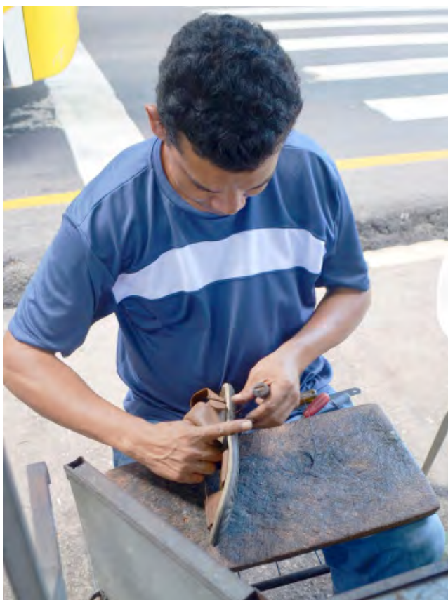
Figura 37. Ato de perfurar e enlaçar a linha no couro da sandália.
